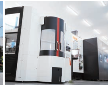
为提高生产效率做贡献的 5轴加工机VARIAXIS i-600 + 自动化系统MPP
