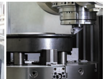
使用 INTEGREX i-800V/8 进行的外径车削加工
