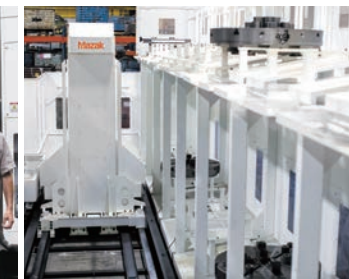
实现夜间无人值守运行的自动化系统 PALLETECH
